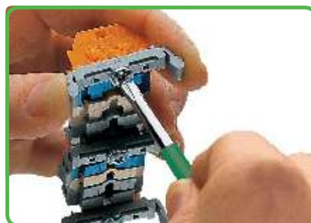
Клеммная сборка с крепежными фланцами, винтовой монтаж адаптера 209-123 (расстояние между адаптерами не должно превышать 35 – 40 мм).
